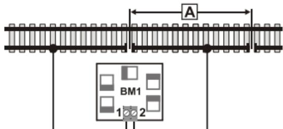
Reliez la borne "1" du BM1 au rail droit situé *avant* la section de freinage.
