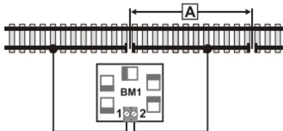
Verbinden Sie die Klemme "1" des BM1 mit der rechten Schiene vor dem Bremsabschnitt.
